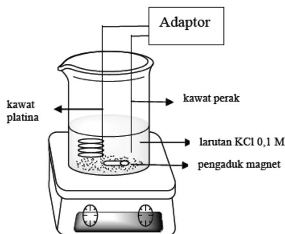
Gambar 2 Proses pelapisan Ag/AgCl pada kawat perak
